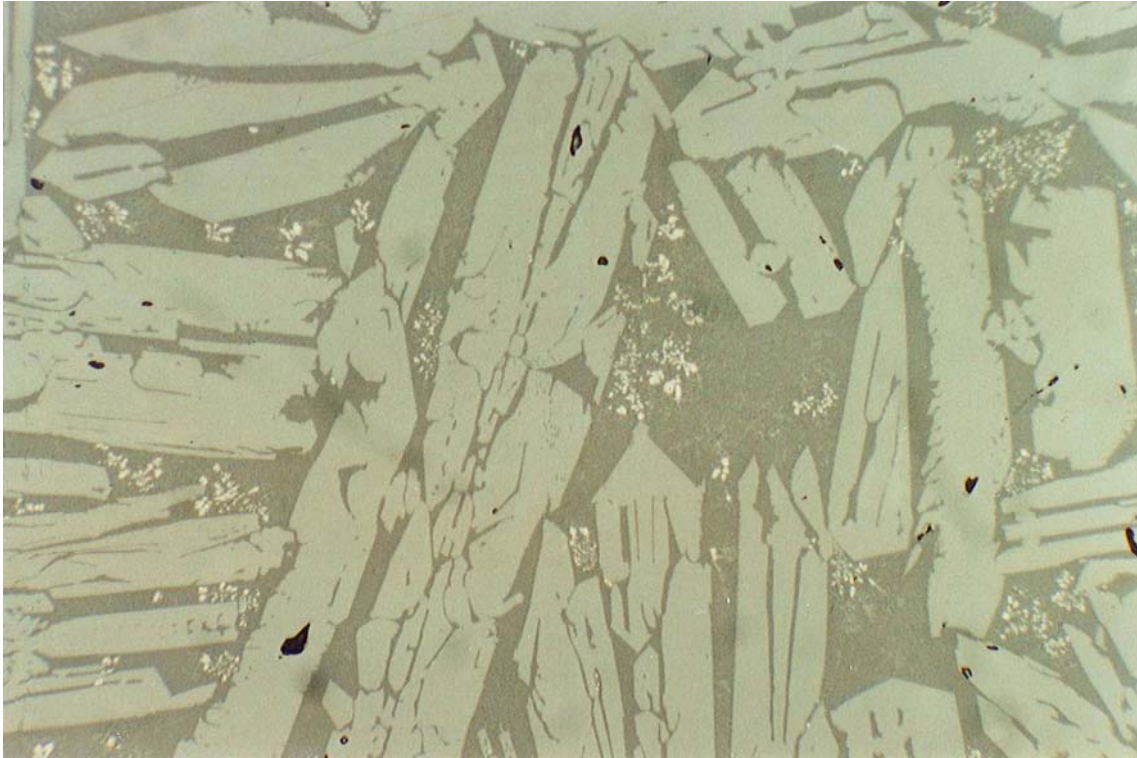
Figur 19. Prov 34, F32080, A10669. Slagg dominerad av olivinlameller (grå) och glas (mörkt grå). Wüstit (ljus) förekommer endast som kristalliter i glaset. Reflekterande belysning, bildyta 0,367×0,551 mm.
