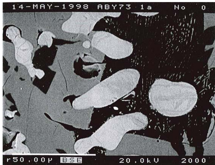
Figur 26. Prov 73, F27810, A27796. Detalj på wüstitdendriter (ljusa) med lameller av magnetit (ljus grå). Dessutom förekommer olivinkristaller (grå) och kristallitförande glas (mörkt grå). Mikrosondfoto (elektronbild), skalstrecket i nedre vänstra hörnet är 50 µm.
